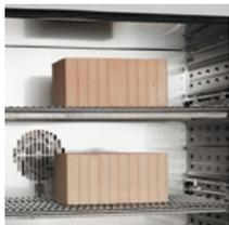
Для надежного и стабильного хранения тяжелых испытуемых материалов.
