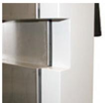
Для удобства прокладки кабеля к испытуемым материалам и простоты загрузки и разгрузки шкафа. Ввод через дверь с размерами 100 x 35 мм, для закрывания прилагается заглушка.
