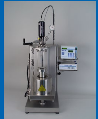
limbo li 350 bar high pressure reactor with cyclone 075 limbo li 350 bar Hochdruck- Reaktor mit cyclone 075
