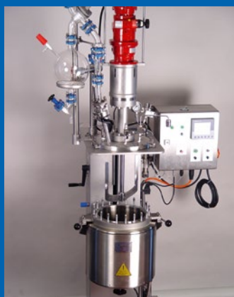
bmd 5400 on 20 liter polymerization reactor bmd 5400 auf 20 Liter Polymerisationsreaktor
