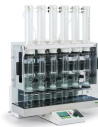
Extraction Unit E-812 / E-816 SOX & HE Специальная экс- тракция жиров
