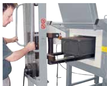
Работа в ящике подачи газа для атмосферы защитного газа с помощью загрузочной тележки
