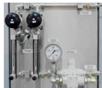
Система подачи негорючих защитных или реакционных газов
