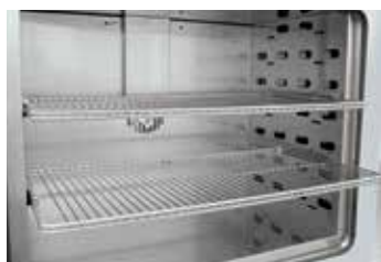
Выдвижные колосниковые решетки для загрузки сушильного шкафа на различных уровнях
