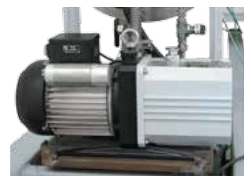
Вакуумный насос для холодного вакуумирования реторты
