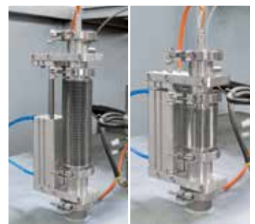
Термозлемент типа S с автоматическим устройством выдвигания для точного управления в нижнем диапазоне температур
