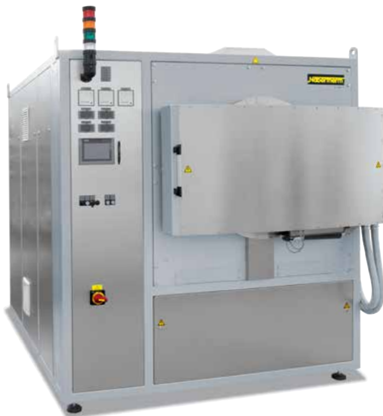
Ретортная печь NRA 150/09 с системой автоматической подачи газа и управления процессами H3700
