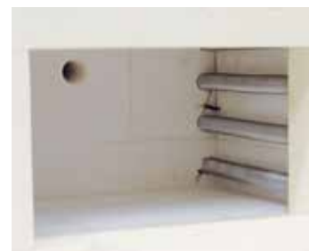
Внутреннее пространство печи с высококачественной изоляцией из огнеупорного легковесного кирпича
