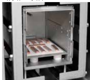
Тепловая обработка медных стержней в водородной среде в ретортной печи VHT 8/16-MO
