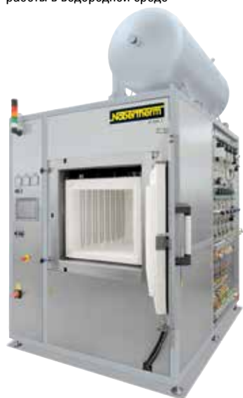
Ретортная печь VHT 100/15-KE H 2 с волокнистой изоляцией и расширительным пакетом для работы в водородной среде, 1500 °С
