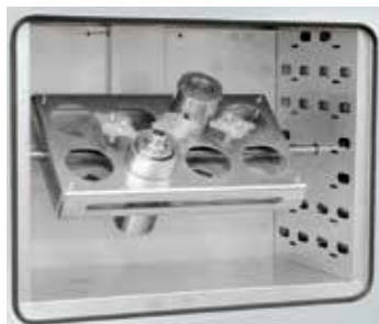
Электрическое поворачивающее устройство в качестве дополнительного оснащения, см. страницу 27
