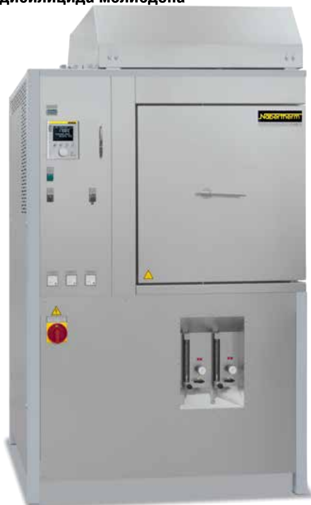
Высокотемпературная печь NT 160/17 с системой подачи газа
