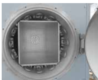
Нагрев внутреннего пространства для ретортных печей NRA ../06
