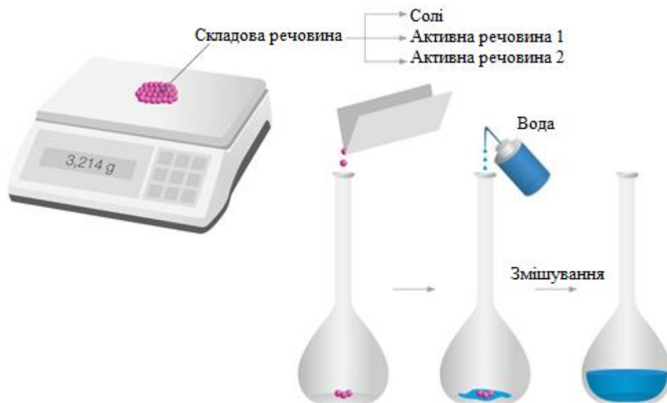
Рисунок 3. При виготовленні настоянок за рецептом точно зважують основні інгредієнти, включаючи солі та активні інгредієнти. На другому етапі виробництва цю суміш розбавляють водою. Концентрацію можна контролювати за допомогою вимірювання густини.
