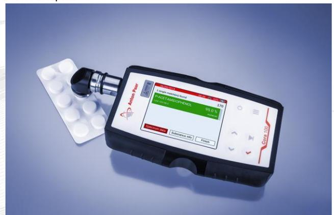
Рисунок 1: Проверка таблеток с помощью рамановского спектрометра Cora 100, AntonPaar.
