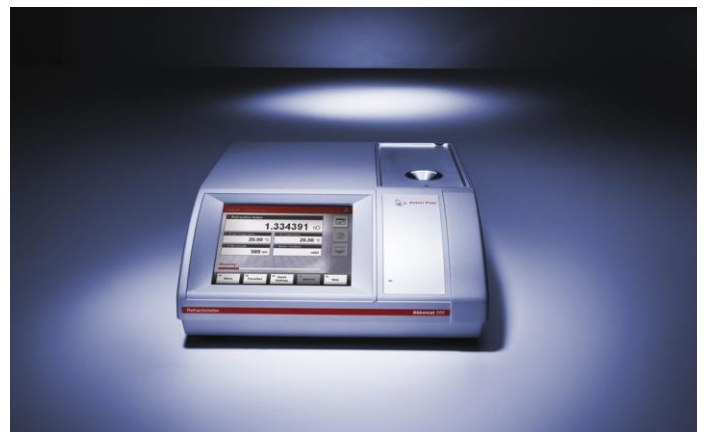
Рис. 1 Рефрактометр Abbemat 550 виробництва компанії Anton Paar дозволяє швидко та економічно визначити співвідношення O/L в арахісових оліях, щоб виготовляти високоякісні продукти.
